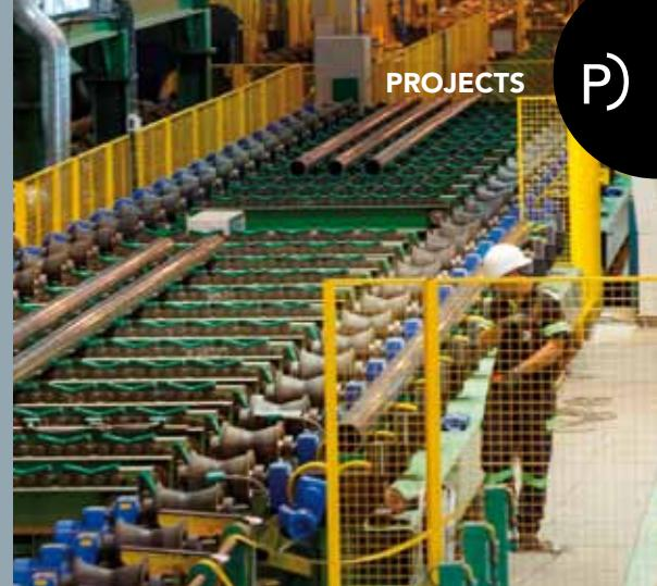
**Línea de acabado orientada a la fabricación de productos tubulares de alto valor añadido para extracción de gas y petróleo (OCTG) y tubos centrales para umbilicos.**
