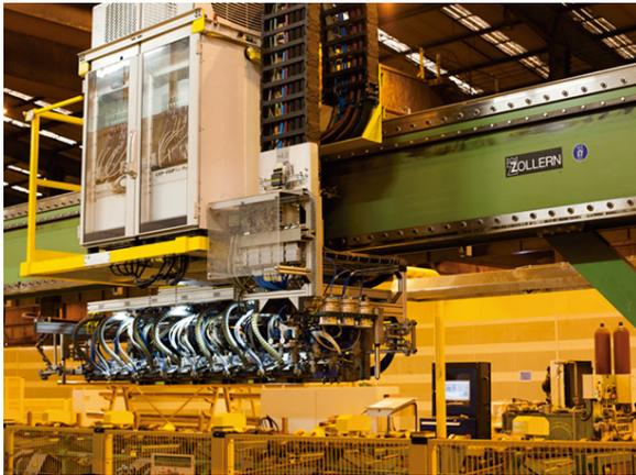
De las inversiones realizadas en el ejercicio destaca la nueva línea de acabado específica para tubos OCTG, realizada en la planta de TTI en Amurrio, que opera en flujo continuo y está totalmente automatizada. Con esta nueva instalación se ha completado la ampliación de la capacidad de producción de este tipo de tubo para el que existen unas buenas perspectivas de crecimiento de la demanda.
